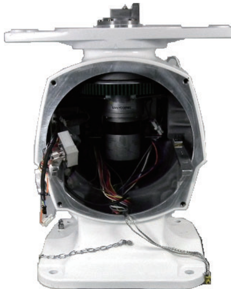
Vue arrière avec capot et module émetteur RTR-101 enlevé.
